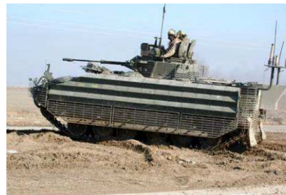
Rys. 2. Warrior z "Wrap-2" (z płytą dodatkowego opancerzenia boków kadłuba i pancernem prętowym)
