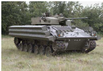
Rys. 2. Warrior z "Wrap-2" (z płytą dodatkowego opancerzenia boków kadłuba i pancernem prętowym)
