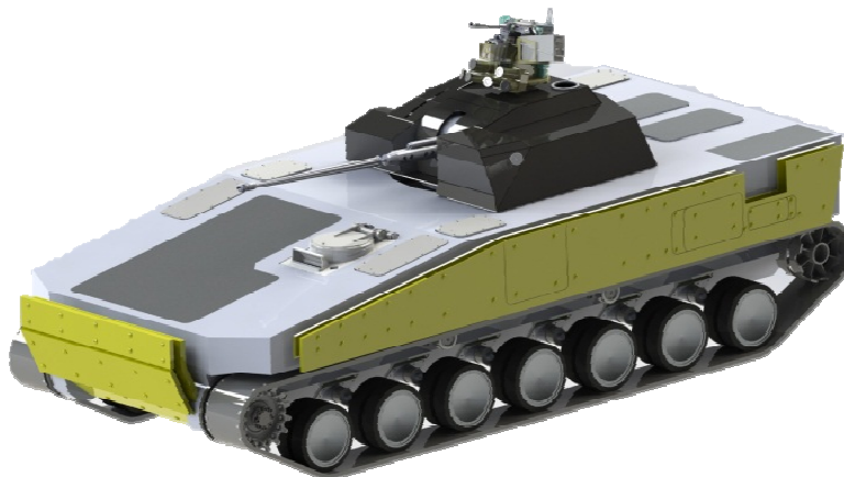
Rys 11. Konceptcja wersji ciężkiej BWP na bazie UMPG z ZSSW
