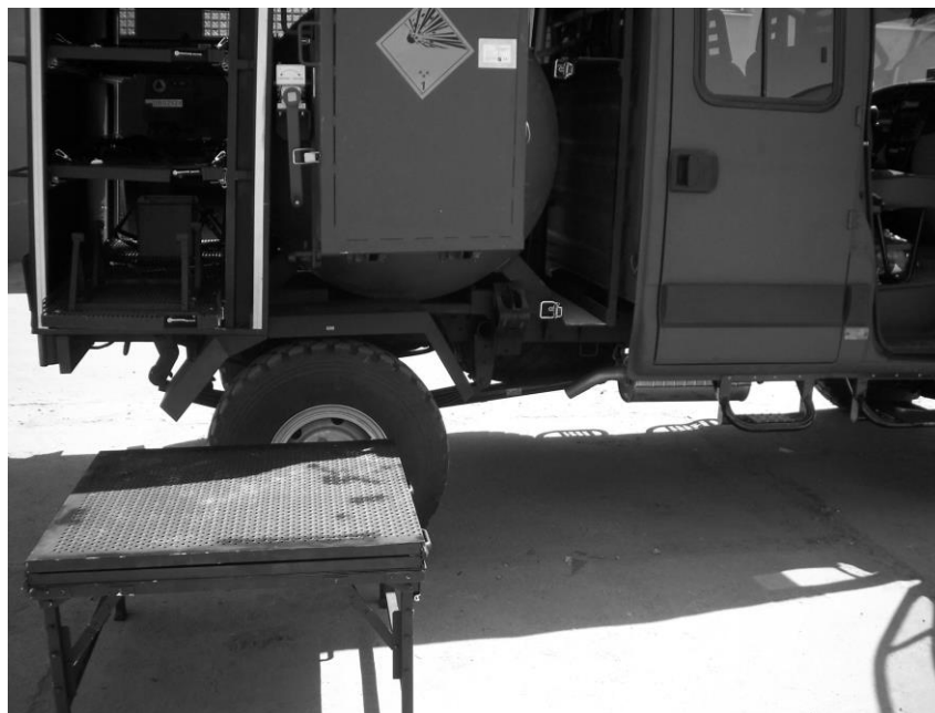
Rys.2. Podest ułatwiający umieszczenie niewybuchu
