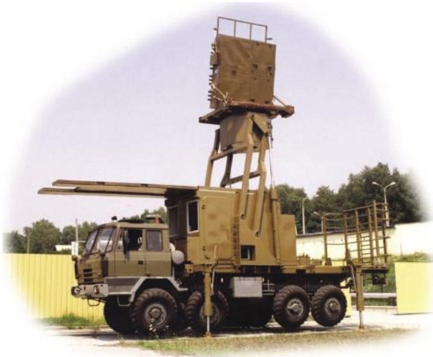
**Fig. 5. CAR-1100 antenna unit**
