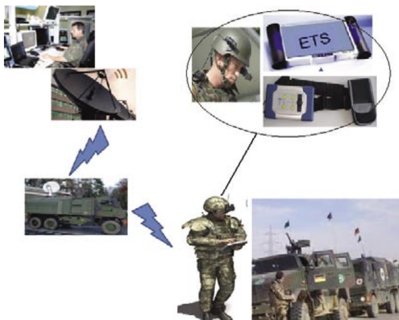
Rys. 2. Koncepcja systemu zdalnego utrzymania sprzętu (telemaintenance) w Wojskach Lądowych Niemiec stanowiącego wsparcie prowadzenia napraw doraźnych podczas działań bojowych [11]
