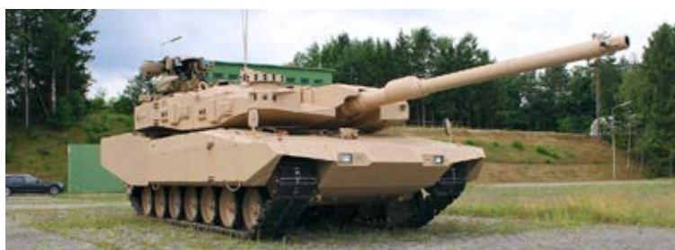
Rys. 4. Propozycja modernizacji czołgu LEOPARD 2A4 do wersji MBT Revolution (fot. Rheinmetall Defence)
