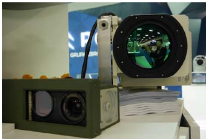
Rys. 3. Zestaw modernizacyjny optyki dla czołgu LEOPARD 2A4/2A5 – Kamera cofania KDN-1T „Nyks” (z lewej) i kamera termowizyjna KLW-1 „Asteria” (z prawej)
