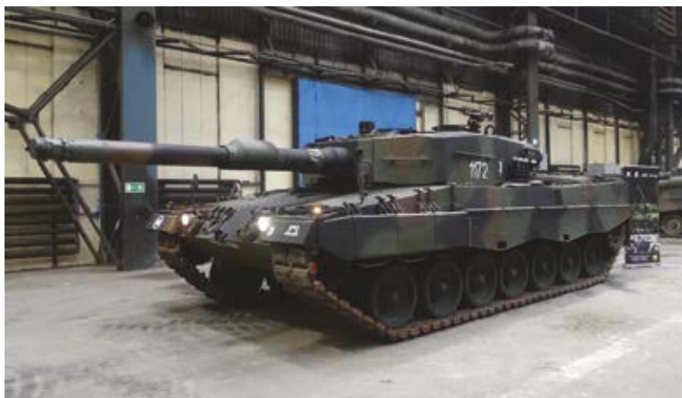
Rys. 1. Czołg LEOPARD 2A4 po wykonanym przeglądzie i naprawach wynikowych (fot. ZM „BUMAR-LABĘDY” S.A.)
