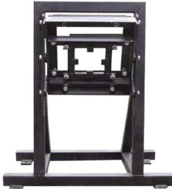
Rys.4. Stanowisko do badania pojedynczych próbek opancerzenia dodatkowego
