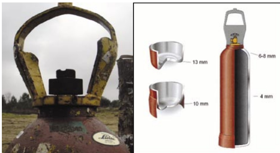
Rys. 2. Butla z acetylenem użyta podczas badań (fot. J. Ejsmont, A. Kołacki)
