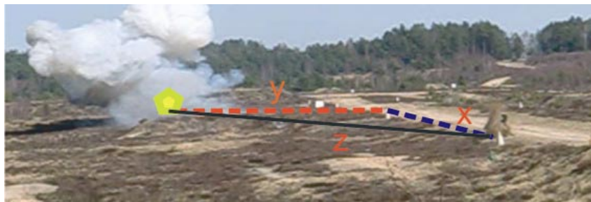
Rys. 9. Schemat – upadku płaszcza butli
