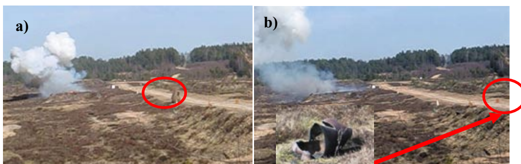
Rys. 6. Miejsce położenia płaszcza butli a) miejsce uderzenia płaszcza butli acetylenowej w ziemię, b) pozycja butli po eksplozji (fot. G. Motrycz)
