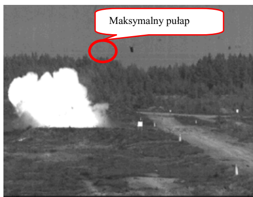
Rys. 5e. 1,075 s od dekompresji – płaszcz butli osiągnął maksymalną wysokość
