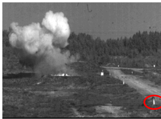
Rys. 5f. 2,686 s od dekompresji - miejsce upadku płaszcza butli
