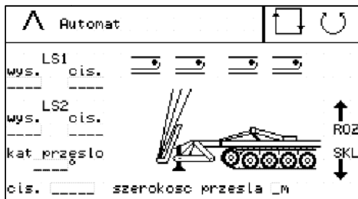
9.2. Przęsło oparte na stopie podporowej – etap sekwencji 3
