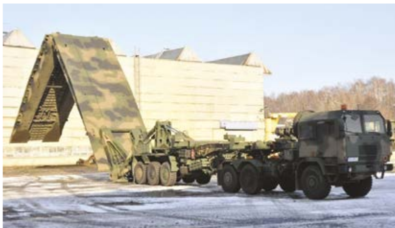
Rys. 1. Układanie przęsła mostu MS-20w terenie otwartym [14]
