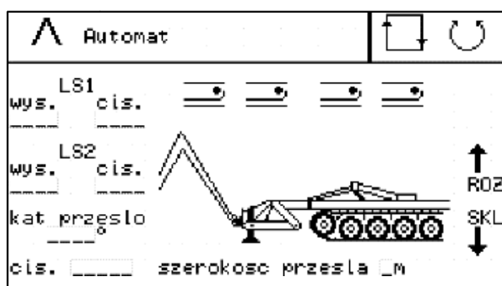
9.3. Przęsło rozwierane – etap sekwencji 4-6
