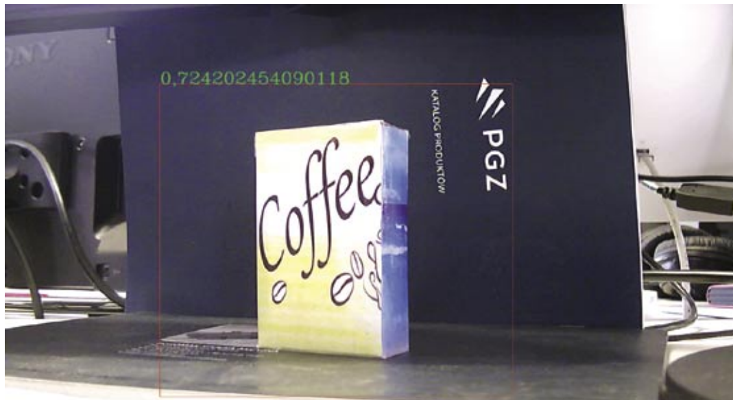
Rys. 2. Przykładowy obraz z kamery z naniesionym obwodem szablonu porównawczego
