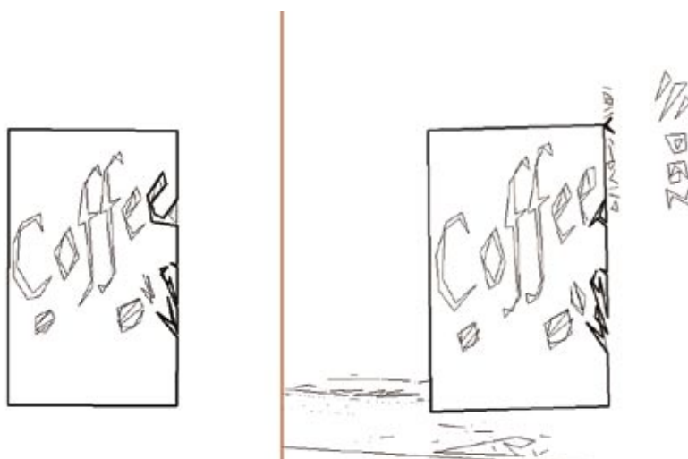
Rys. 4. Porównanie konturów szablonu (po lewej) i obrazu z kamery
