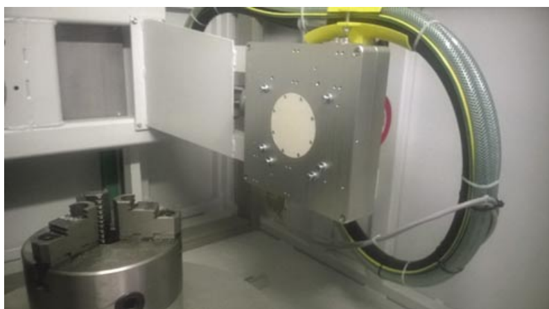
Rys. 1. Wnętrze urządzenia MU 2000 – widoczna lampa rentgenowska 160 kV
