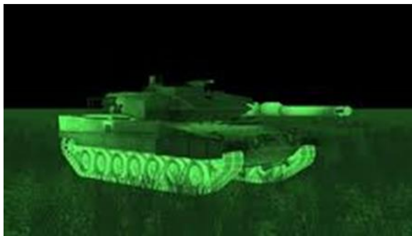
Rys. 4. Obraz z kamery termowizyjnej wozu bojowego z układem napędowym z tyłu
