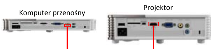
Rys. 8. Konfiguracja symulatora S-MS-20 bez pulpitu wynośnego
