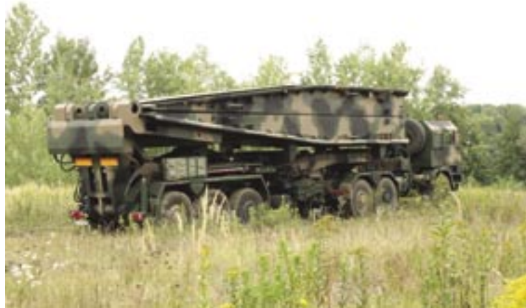
Rys. 1. Most samochodowy – most wsparcia MS-20
