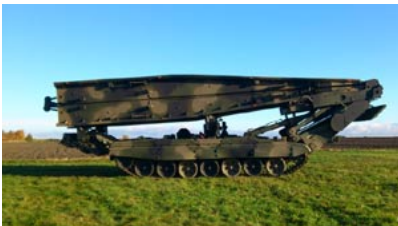
Rys. 3. Most gąsienicowy – most szturmowy MG-20
