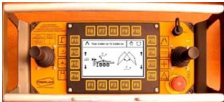
Rys. 6. Interfejs HMI – płyta czołowa pulpitu wnośnego MS-20
