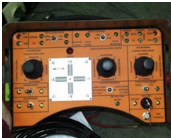
Rys. 5. Pulpit sterowania przeznaczony do systemu poziomowania stacji radiolokacyjnej
