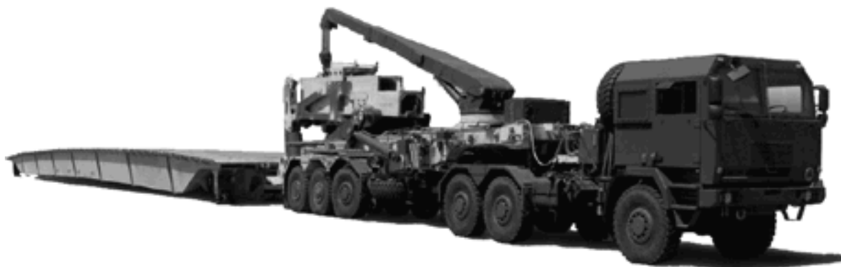
Rys. 1. Most przewoźny MS – 40 – pojazd układający
