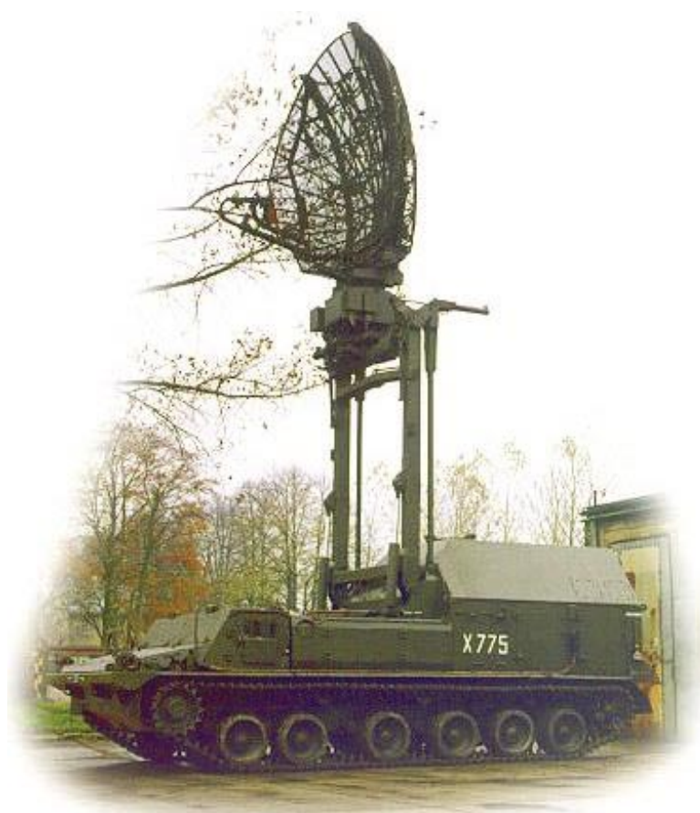
Rys. 2. Stacja radiolokacyjna NUR-21M na podwoziu gąsienicowym SPG-1M
