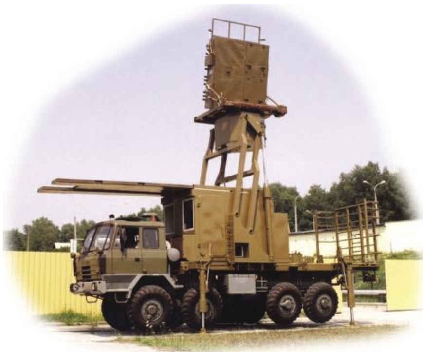
Rys. 5. Jednostka antenowa CAR-1100
