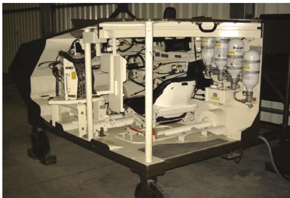
Rys. 4. Trener szkolenia kierowców czołgu Leopard 2A4 typu stend „CDT” [8]
