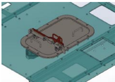
Rys. 15. Właz awaryjny w dnie symulatora
