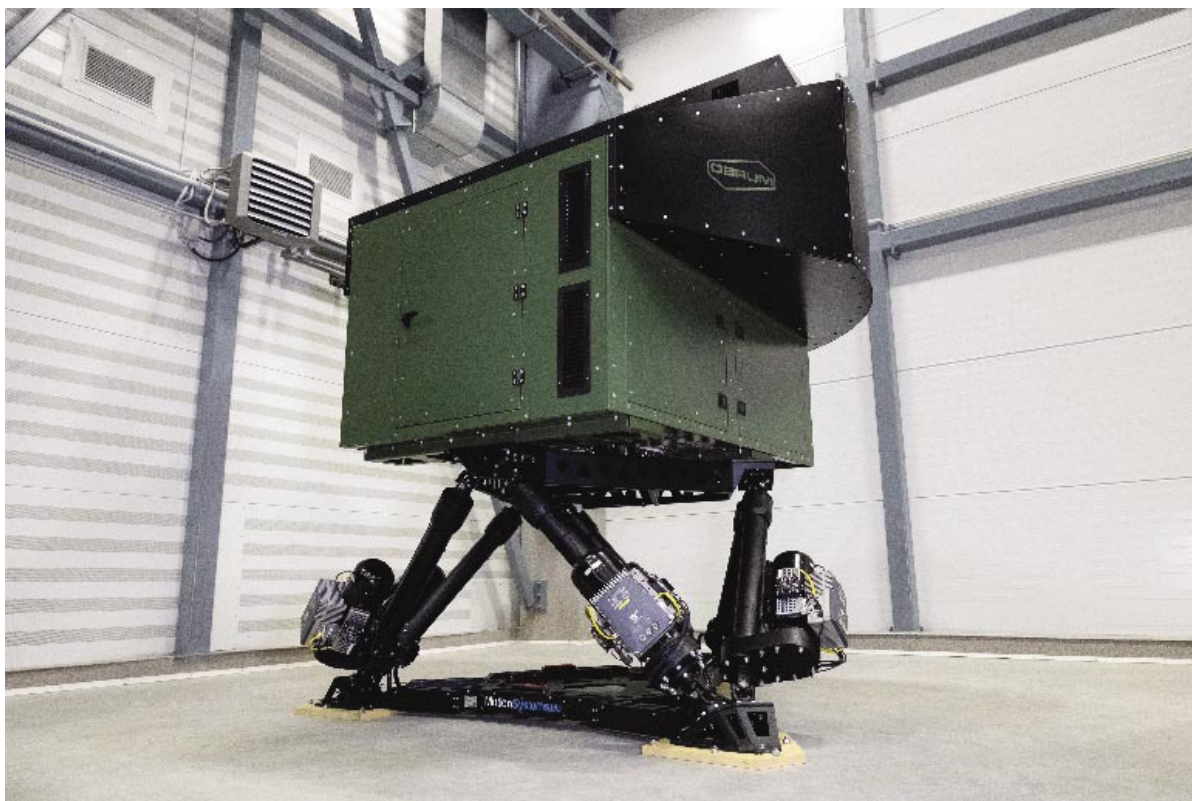
Rys. 1. Symulator jazdy czołgiem Leopard 2A4 – SJCL (fot. OBRUM sp. z o.o.)
