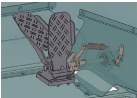
Rys. 7. Imitator pedału przyspieszenia
