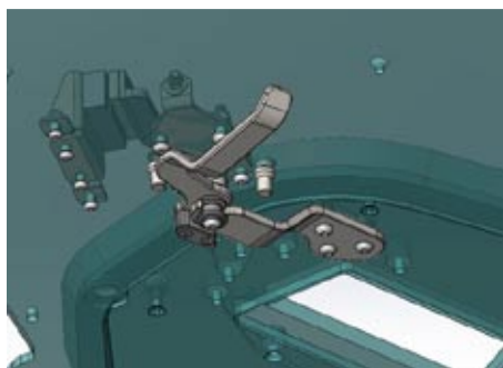
Rys. 13. Blokady władu kierowcy w pozycji zamkniętej
