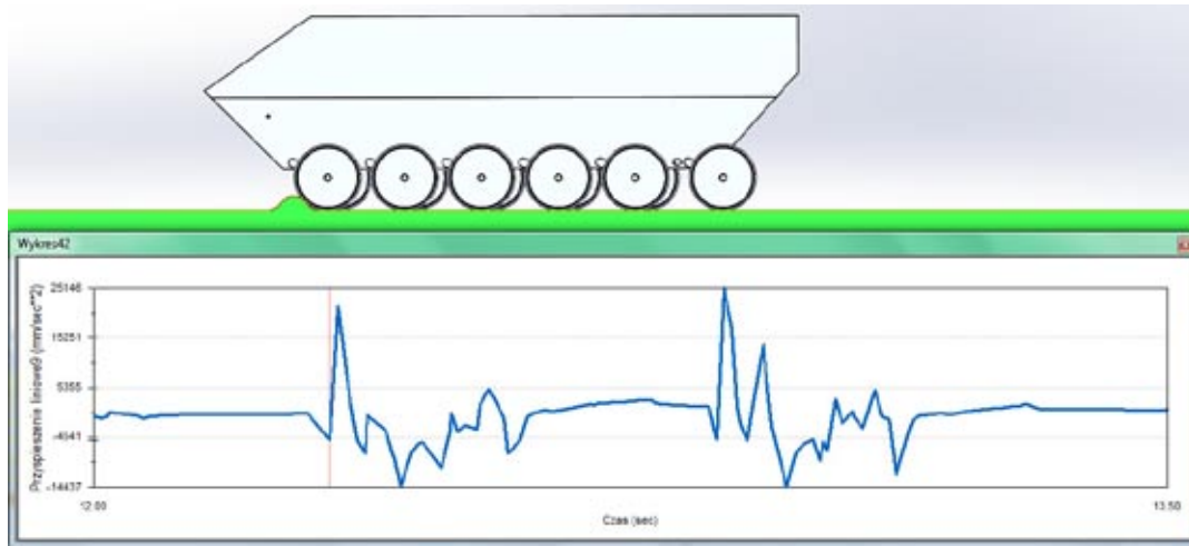
Rys. 11. Wykres przyspieszenia przedniej krawędzi kadłuba (pojazd pokazano tuż przed dojechaniem do przeszkody, maksymalne przyspieszenie 25.146 m/s 2 )
