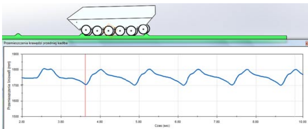
Rys. 17. Wykres przemieszczenia przedniej krawędzi kadłuba (pojazd pokazano tuż przed dojechaniem do 2. garbu)
