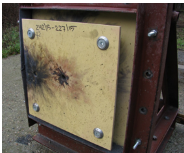
Rys. 1. Próbkę opancerzenia na stanowisku badawczym
