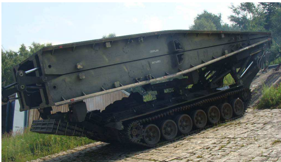
Rys. 1. Most gašienicowy DAGLEZJA-G (MG-20)
