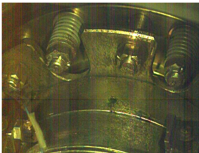
Rys.5. Widok stop klatki z rozruchu silnika – widok prototypowego sprzęgła
