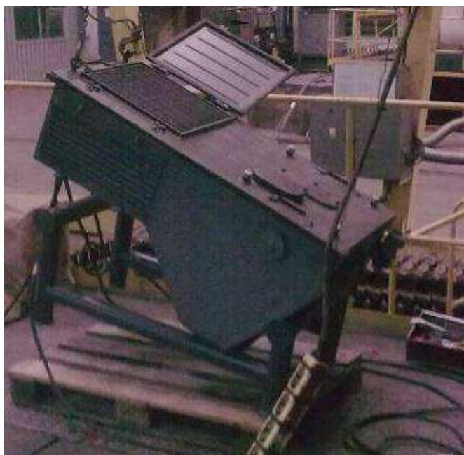
Rys.3. Dodatkowy zespół prądotwórczy APU podczas badań funkcjonalnych
