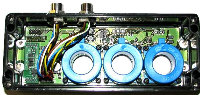
Rys. 1. Moduł pomiarowy prądów [14]
