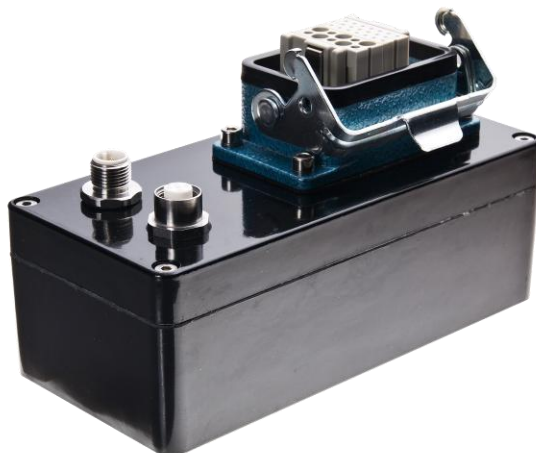
Rys. 2. Moduł wejść - wyjść analogowych i cyfrowych MWW-1/1 wersja pierwsza [14]
