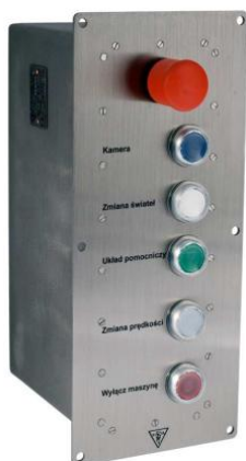
Rys. 18. Pulpit sterowniczego maszynisty PSM-01 (KOMAG 08ATEX257X) [8]
