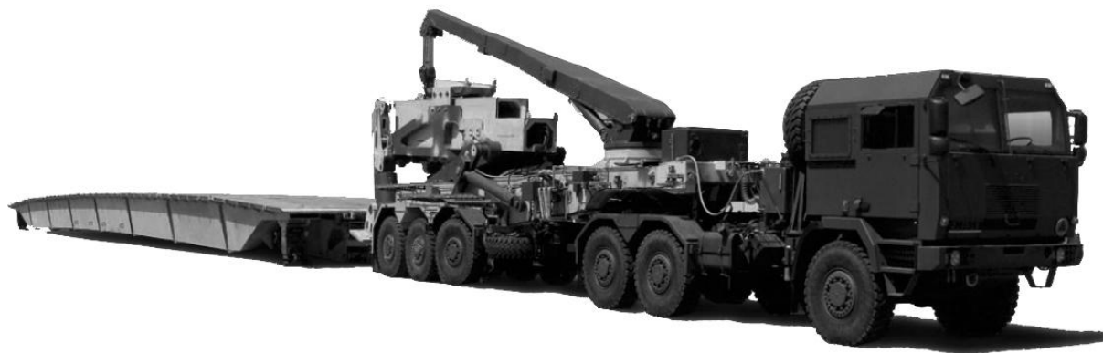
Rys. 1. Most przevoźny MS – 40 – pojazd układający
