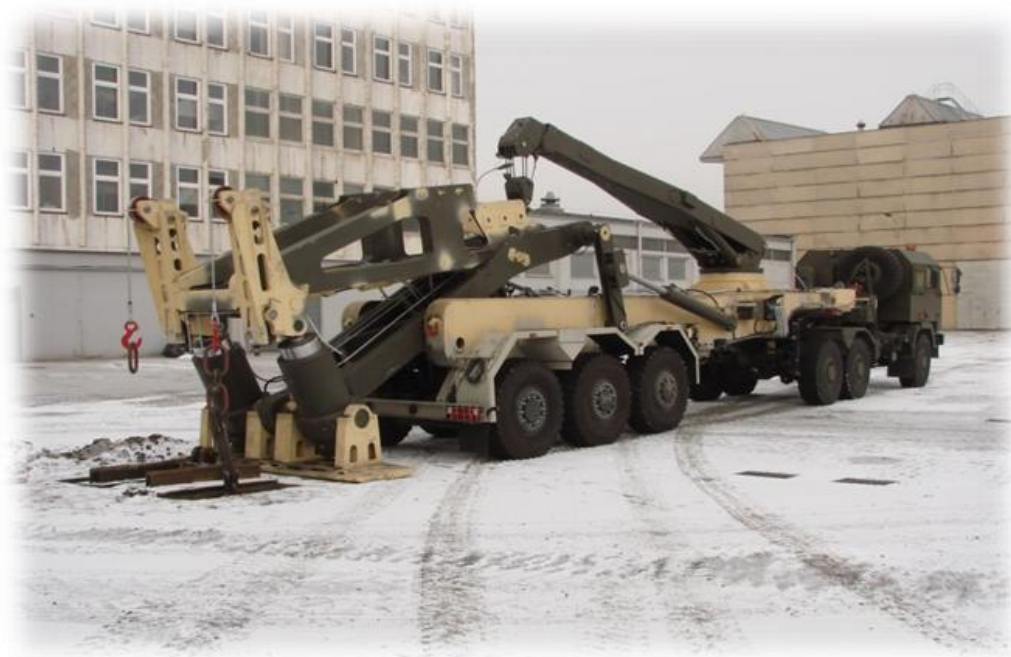
Rys. 4. Widok pojazdu układającego most MS-40
