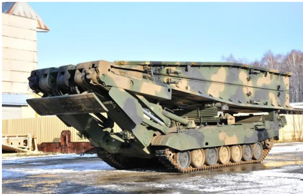
Rys. 3. Widok mostu MG-20 na podwoziu gąsienicowym
