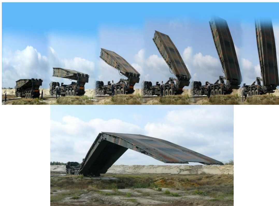
Rys. 2. Most samochodowy MS-20 – kolejne fazy rozkładania
