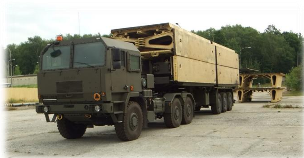
Rys. 4. Widok pojazdu układającego most MS-40
