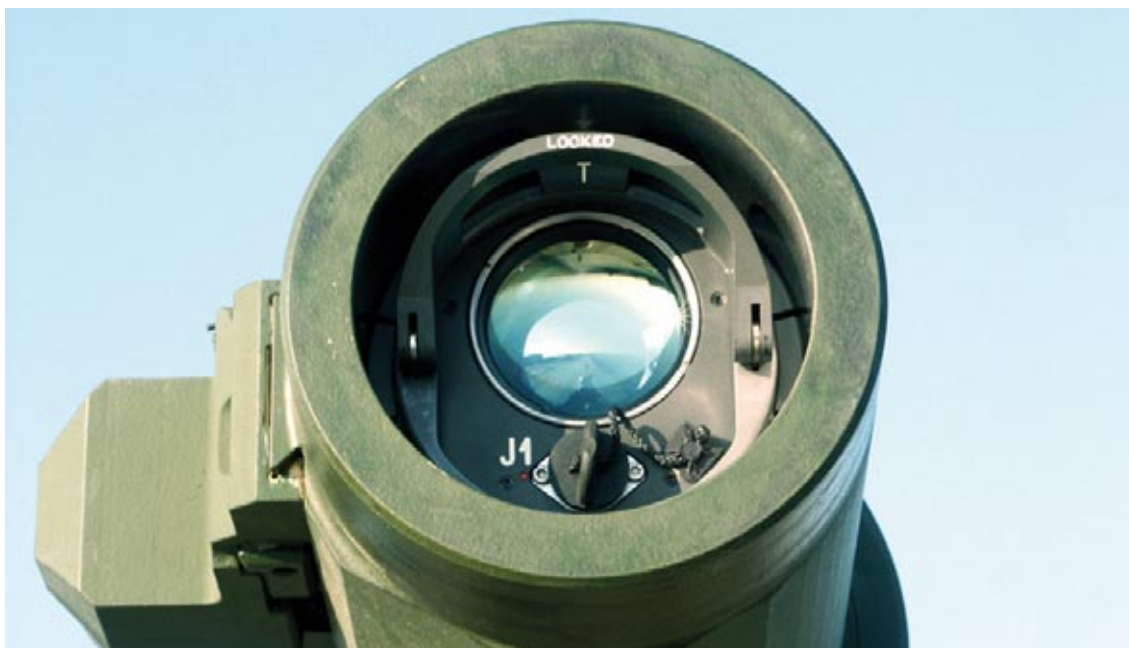
Rys. 2. Wylot lufy armaty 120 mm z widocznym wewnątrz nadajnikiem laserowym. (Źródło: Saab Group)
