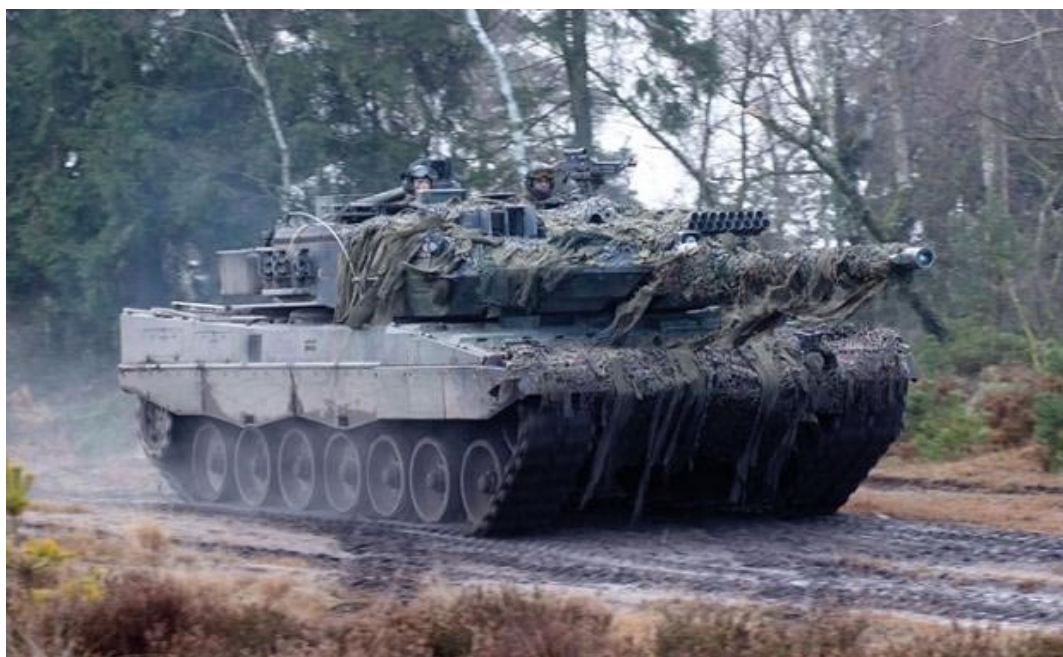
Rys. 1. Czołg Leopard 2 z widocznym u wylotu lufy nadajnikiem laserowym systemu BT 46 firmy SAAB. Na lufie umieszczona jest także wyrzutnia dymna symulująca dym po strzale armatnim. (Źródło: Saab Group)
