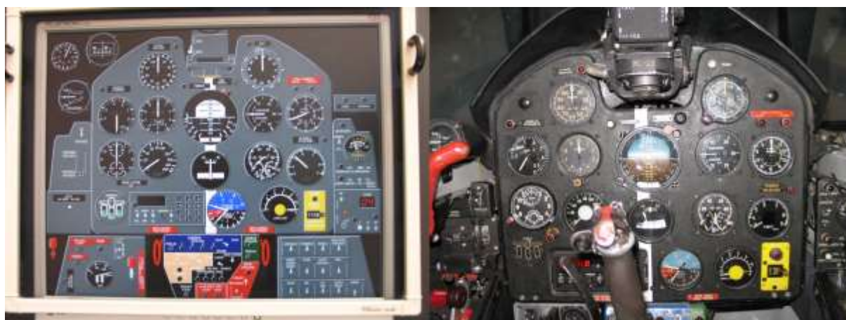
Rys.4. Zestawienie wizualizacji w ramach stanowiska instruktora (po lewej) i tablicy imitatorów ze stanowiska kursanta (po prawej)
