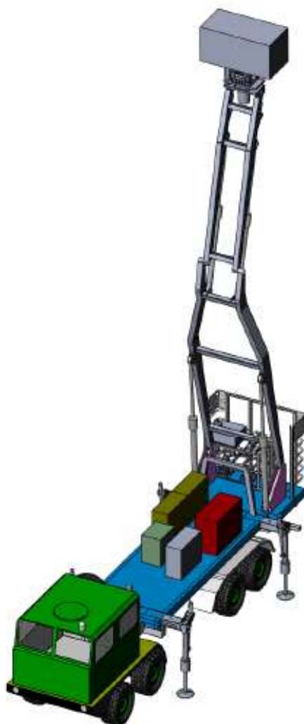
Rys. 2. SHORAD w pozycji pracy z rozmieszczonymi zespołami radaru oraz zabudową zespołów własnych
