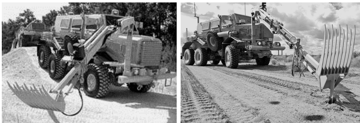
Rys. 14. Zdalnie sterowane ramię robocze pojazdu Buffalo
