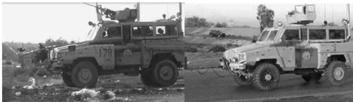
Rys. 20. Pojazdy RG-31A2 wyposażone w dmuchawę i urządzenie systemu Rhino
