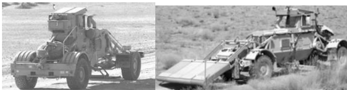
Rys. 5. Pojazd Husky podczas sprawdzania drogi marszu na występowanie IED przy użyciu wykrywacza pulsacyjno-indukcyjnego i georadaru
