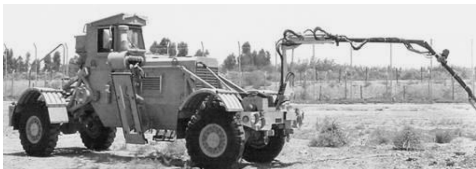
Rys. 8. Husky w trakcie pracy hydraulicznym ramieniem VIA
