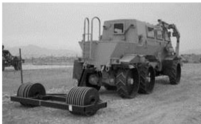
Rys. 17. Pojazd Buffalo wyposażony w stalowe koła oraz w holowany trał walcowy
