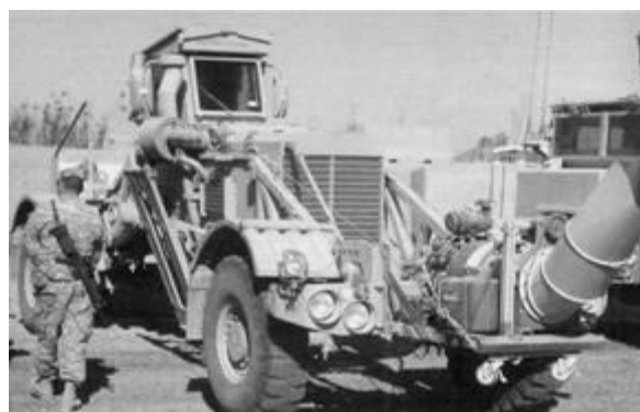
Rys. 10. Pojazd Husky wyposażony w zintegrowaną z systemem Rhino dmuchawę Cyclone
