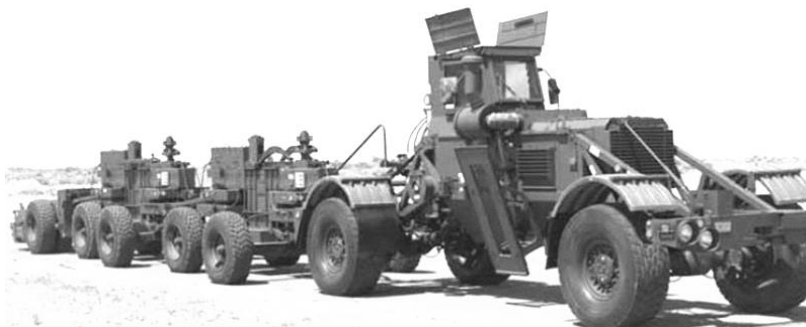
Rys. 6. Pojazd Husky z zestawem Duisendpoot
