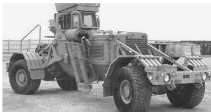
Rys. 9. Husky wyposażony w skrętne obie osie pojazdu
