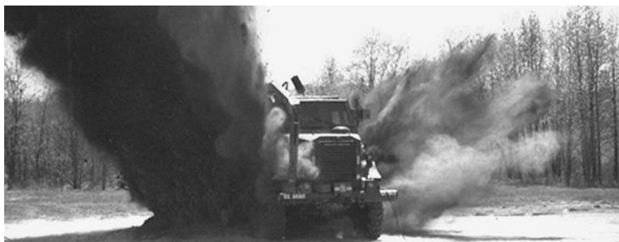
Rys. 12. Wybuch ładunku TNT pod kadłubem pojazdu Buffalo
