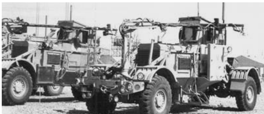
Rys. 7. Pojazdy Husky z dodatkowym wyposażeniem: zagłuszarką IED Warlock/Duke, dodatkowym bocznym opancerzeniem kabiny, systemem Rhino II oraz hydraulicznym ramieniem VIA
