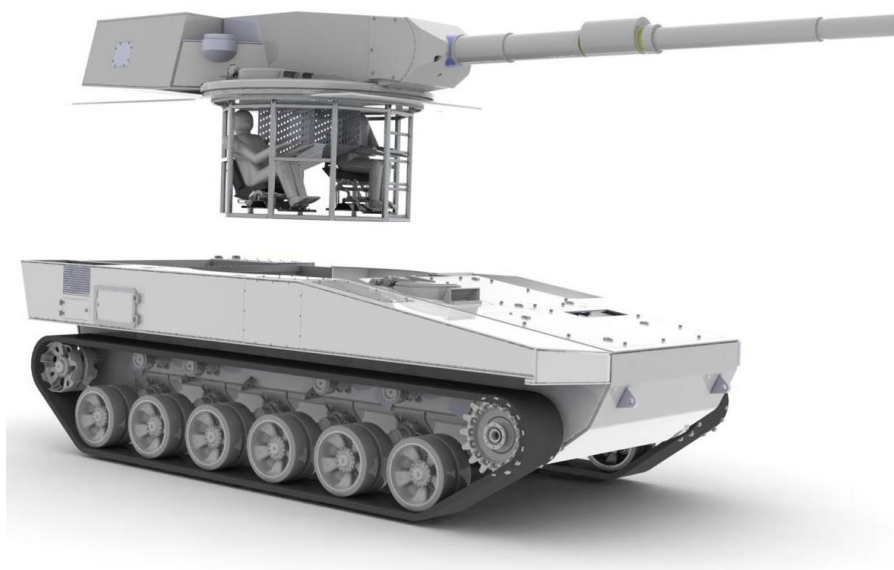
Rys.2. Modułowa budowa pojazdu gaśnicowego
