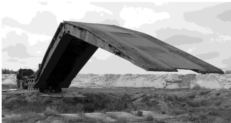
Rys. 3. Układanie mostu MS-20 na przeszkodzie terenowej
