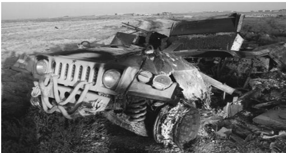
Rys. 1. HMMWV po wybuchu miny o masie 6 kg [[5]]
