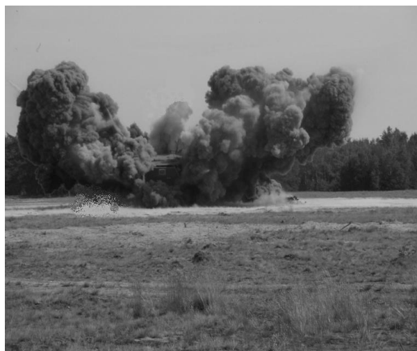
Rys. 8. Wybuch ładunku TNT pod pojazdem
