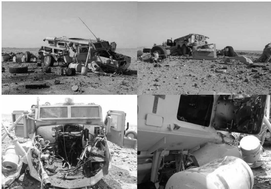
Rys. 2. Cougar 6x6 zniszczony atakiem IED o masie ładunku ok. 100 kg [[6]]
