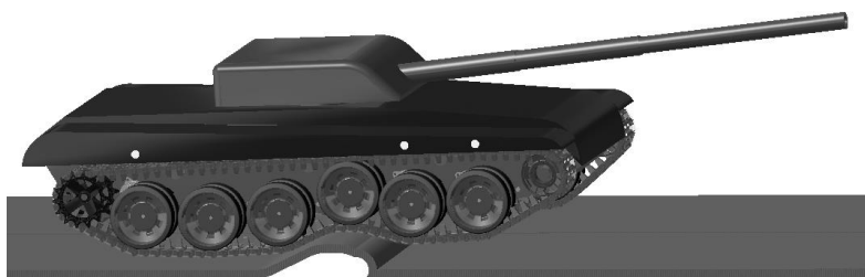
Rys. 9. Przejazd modelu pojazdu gąsienicowego przez przeszkodę o wysokości 30 cm
