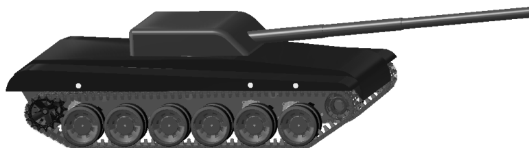
Rys. 3. Złożenie wszystkich elementów modelu CAD czołgu z zawieszeniem
