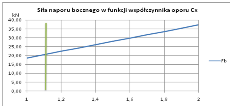
Rys. 9. Zależność siły naporu bocznego od współczynnika oporu
