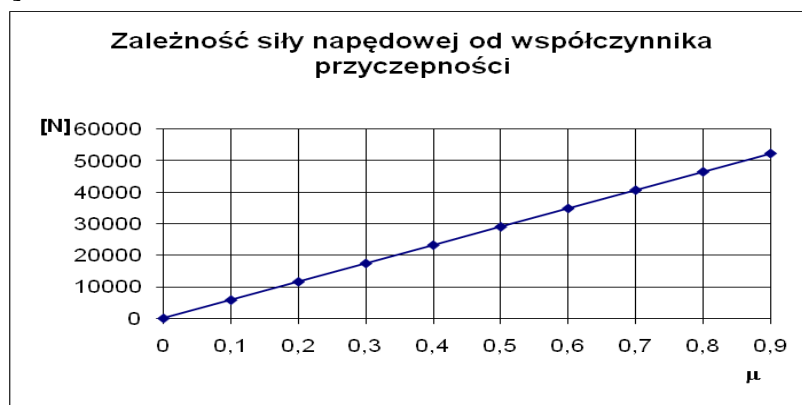
Rys. 4. Siła napędowa w funkcji współczynnika przyczepności
