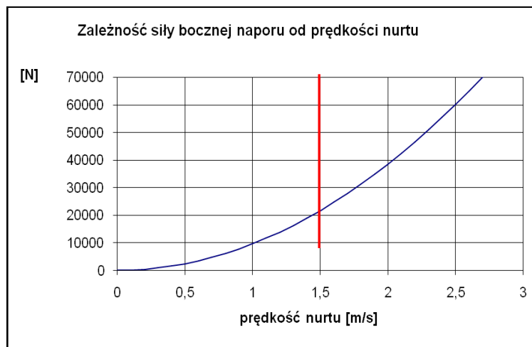
Rys. 3. Napór boczny w funkcji prędkości nurtu
