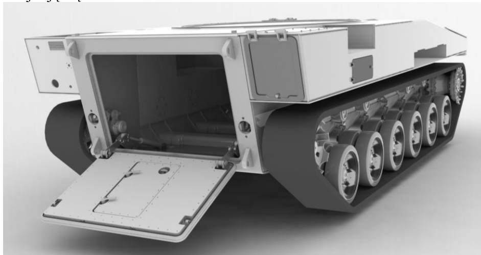
Rys. 7. Tylna rampa z napędem hydraulicznym
