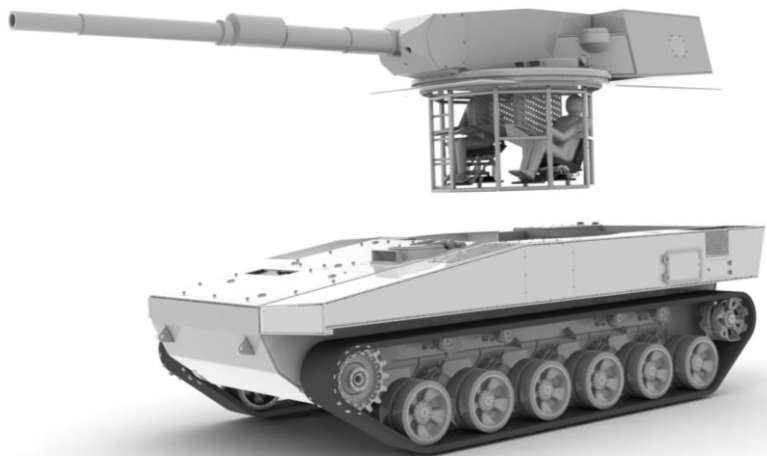
Rys. 12. Moduł zadaniowy– wieża z armatą kal. 120 mm
