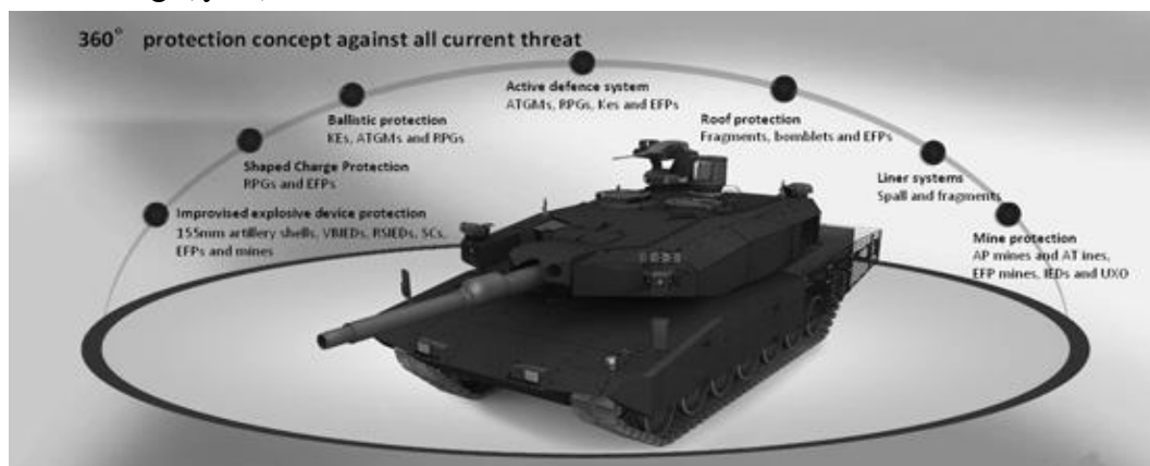
Rys 2. Koncepcja połączonej obrony współczesnego czołgu przed różnymi zagrożeniami
