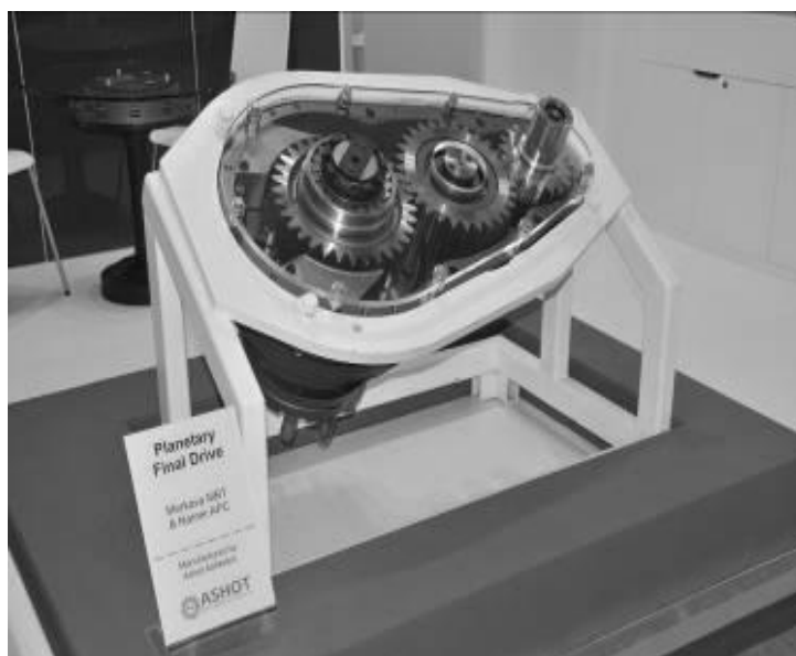
Rys 6. Nowoczesne elementy zawieszenia i transmisji czołgu Merkawa 4
