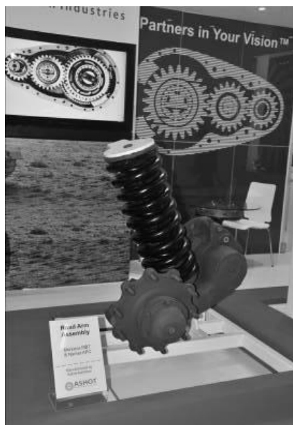
Rys 6. Nowoczesne elementy zawieszenia i transmisji czołgu Merkawa 4
