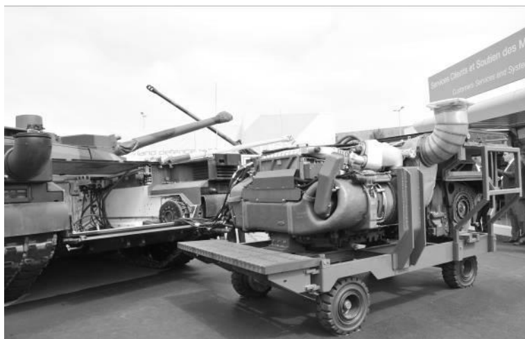
Rys 3. Przedział silnikowy i power-pack czołgu Leclerc
