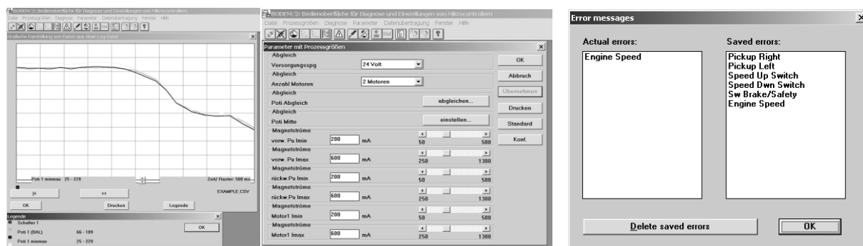
Rys. 7. Widok ekranu programu diagnostycznego BODEM: okno monitorowania przebiegu parametrów, okno zmiany parametrów, okno błędów
