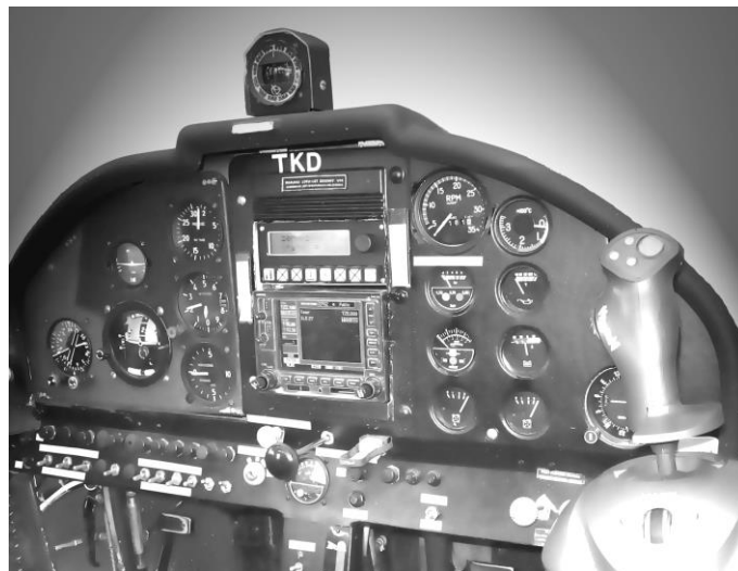
Rys. 1. Kokpit eksperymentalnego samolotu PZL-110 „Koliber”
