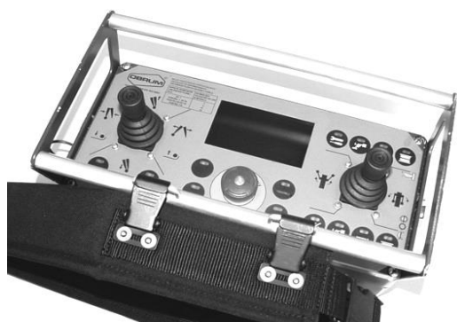
Rys. 3. Pulpit wynośny mostu MS-20
