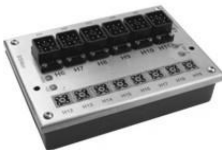
Rys.3. Blok Sterowania Hydrauliki i Kontroli Mechanizmów BSHkm
