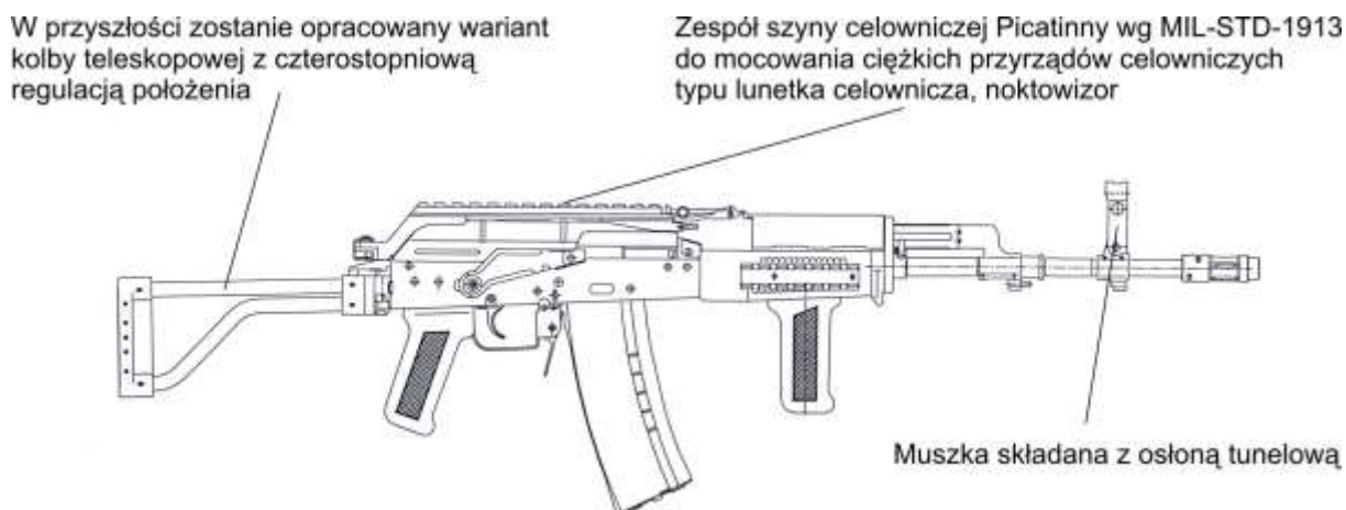
Rys. 2. Beryl wz. 96 z proponowanymi zmianami.
