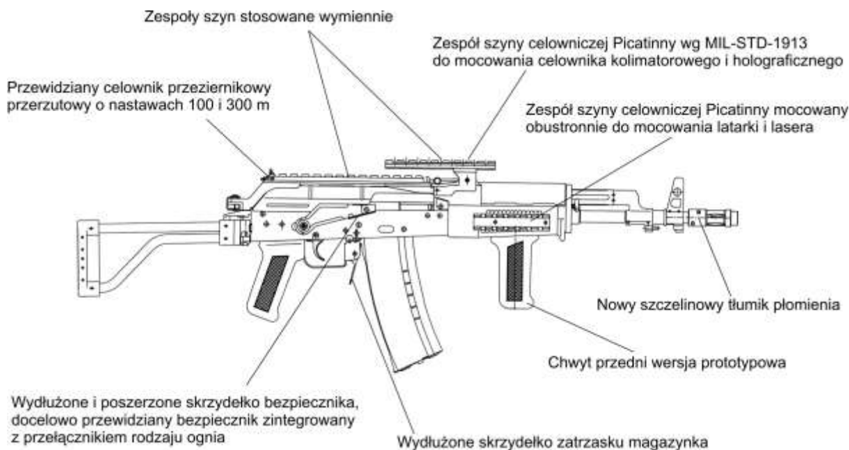
Rys. 1. Beryl wz. 96 z proponowanymi zmianami.
