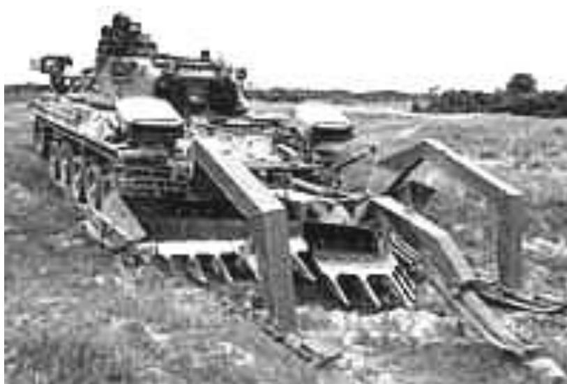
Rys. 4. Maszyna rozminowująca (GIAT).
