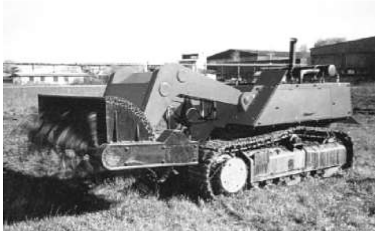
Rys. 6. Maszyna rozminowująca RM-KA 01(DEMIN-KA).
