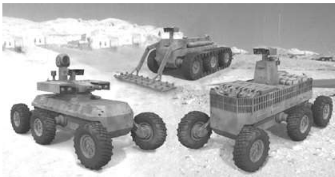
Rys. 10. Wielowariantowy bezzałogowy pojazd bojowy i logistyczny MULE (Lockheed Martin).
