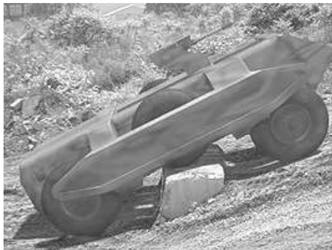
Rys. 7. Bezzałogowy pojazd bojowy SPINNER (National Robotics Engineering Consortium).
