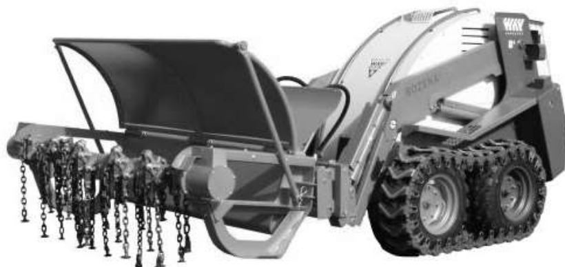
Rys. 3. Maszyna BOZENA 4 z osprzętem rozminowującym (WAY INDUSTRY).
