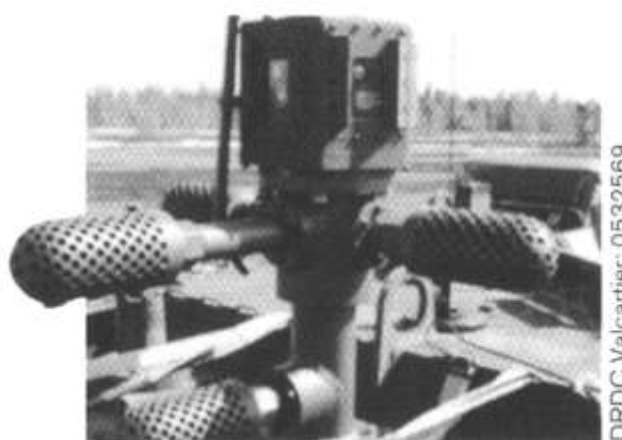
Rys. 10. Odstrzeliwana kabina oraz testowany obecnie czujnik akustyczny.
