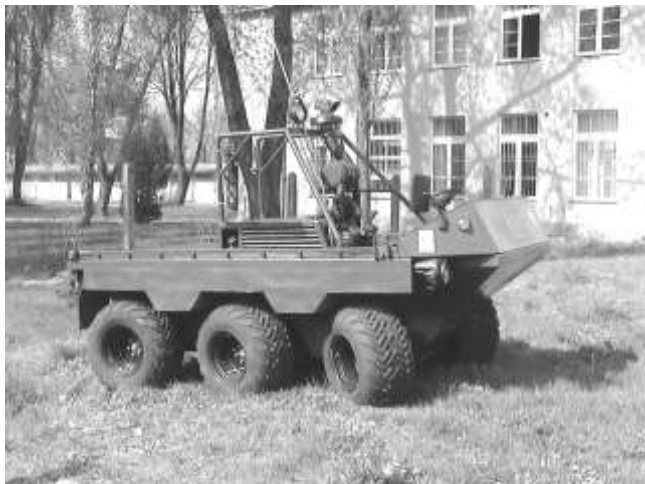
Rys. 4. Zdalnie sterowany pojazd Lewiatan 5 SG: a) podczas jazdy terenowej; b) podczas pokonywania przeszkody wodnej.
