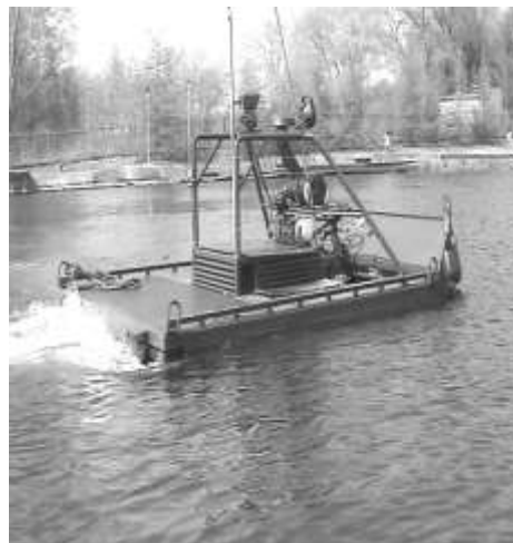
Rys. 4. Zdalnie sterowany pojazd Lewiatan 5 SG: a) podczas jazdy terenowej; b) podczas pokonywania przeszkody wodnej.
