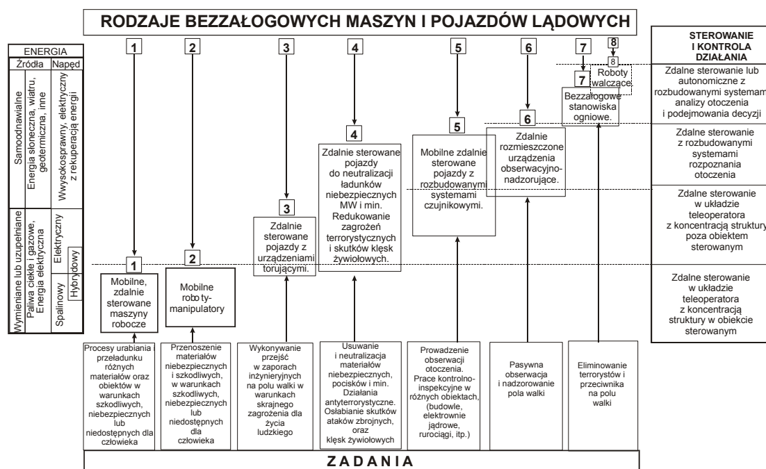
Rys. 1. Zadania, rodzaje i warianty funkcjonalne bezzałogowych maszyn i pojazdów lądowych.
