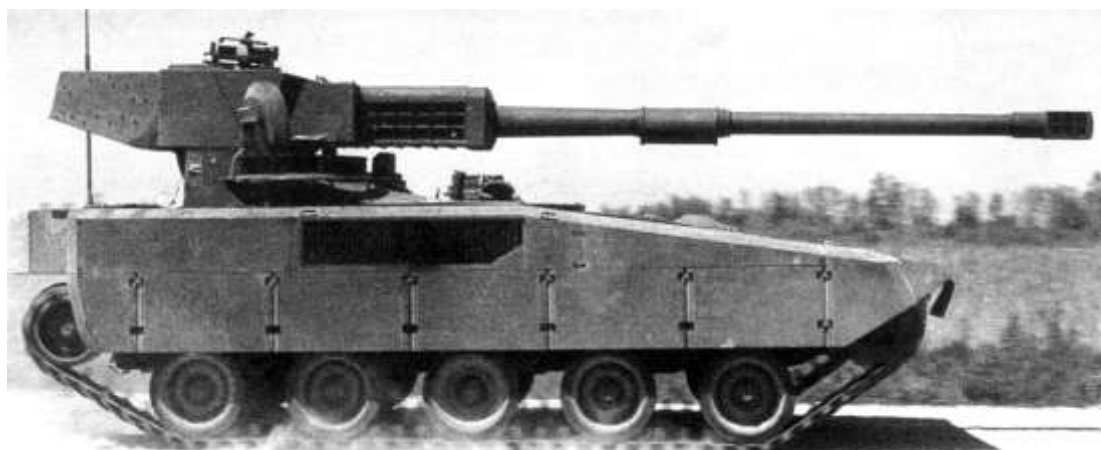
Rys.6. Jeden z prototypów wyposażony w armatę kal. 105 mm osadzoną na wysięgniku. Badania potwierdziły słuszność takiej koncepcji
