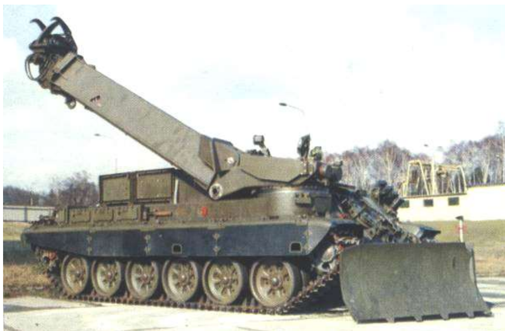
Rys.2. Maszyna inżynieryjno-drogowa MID
