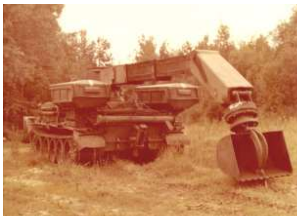
Rys.7. Manipulator z łyżką koparkową w pozycji przedsiębiornej
