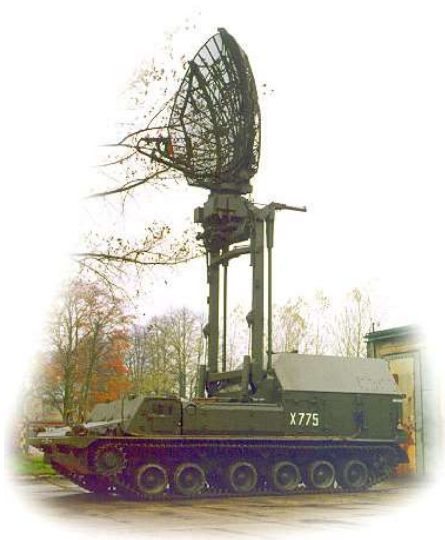
Rys.1. Stacja radiolokacyjna NUR-21M na podwoziu gąsienicowym SPG-1M
