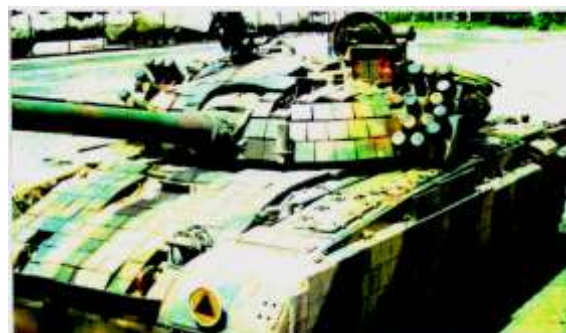
Rys. 4. Polski czołg PT-91 Twardy z kasetami reaktywnymi ERAWA-1 i ERAWA-2 (II generacja) i absorberem mikrofalowym
