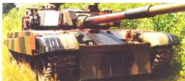
Rys. 5. Polski czołg PT-91 Twardy z szybko montowanymi blokami kaset reaktywnych ERAWA-1 i ERAWA-2 (III generacja)
