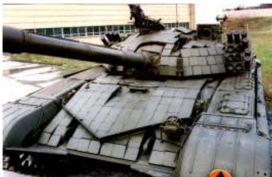
Rys. 3. Polski czołg PT-91 Twardy z kasetami reaktywnymi ERAWA-1 (I generacja)
