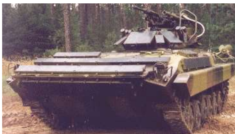
Rys. 2. Polski BWP-1 z pancierzem kompozytowo-reaktywnym CERAWA-1 chroniącym przed przebiciem głowicą PG-7 i 14,5 mm pociskami AP
