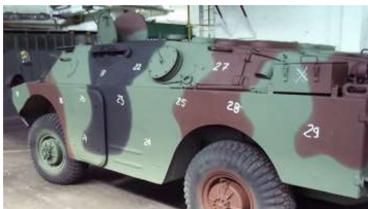
Rys. 6. Opancerzony samochód rozpoznania pola walki z absorberem mikrofalowym typu powłoka malarska
