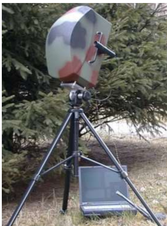
Rys. 7. Uniwersalna radiolokacyjna stacja balistyczna RUBIN do określania prędkości lotu pocisków
