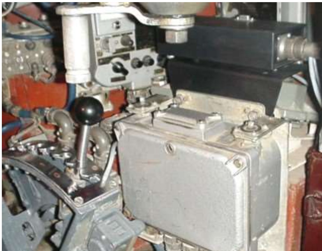
Rys.2. Rejestrator RCzPB-01 zamontowany w przedziale kierowania czołgu PT-91
