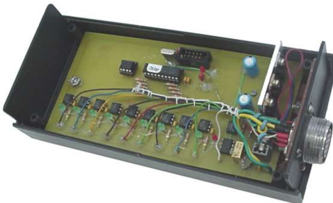
Rys.3. Moduł pomiarowy rejestratora RCzPB-01 (po zdjęciu górnej pokrywy)
