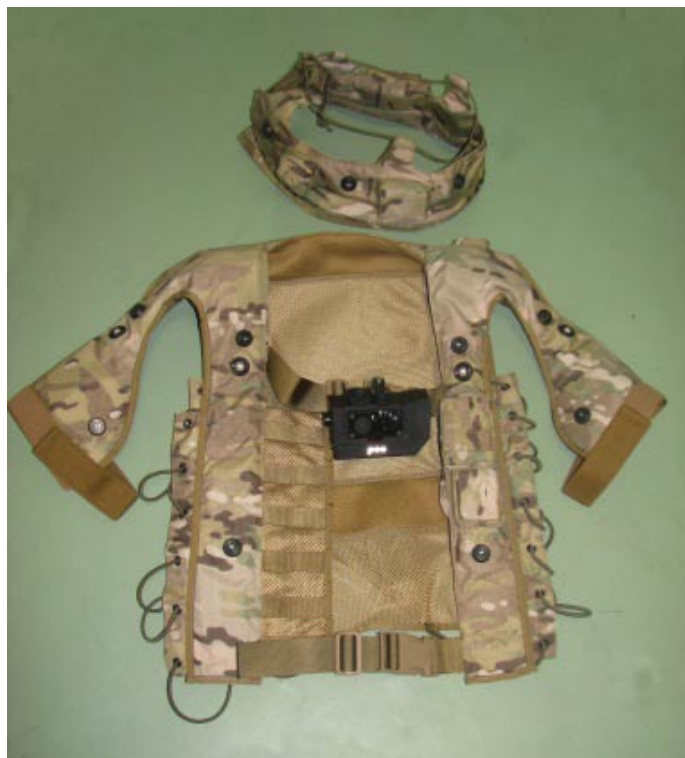
Rys. 2. Zestaw symulatora dla żołnierza składający się z modułu odbiorczego zakładanego na tors i hełm oraz nadajnika laserowego. Nadajnik komunikuje się z dekoderem umieszczonym w odbiorniku torsowym poprzez lokalną sieć radiową. Dekoder ten następnie przesyła dane do osobistego łącza radiowego pracującego w sieci globalnej. (Źródło: PCO S.A.)
