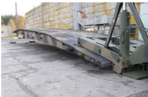
Rys. 7. Moment awaryjnego zatrzymania przęsła na wysokości 1 m nad ziemią
