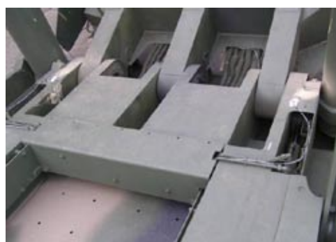
Rys. 6. Widok rozmieszczenia tensometrów na układaczu
