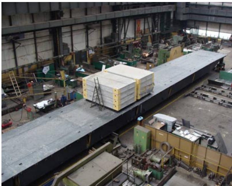
Rys. 7. Pręśła w trakcie próby „P” – dla obciążenia gąsienicowego
