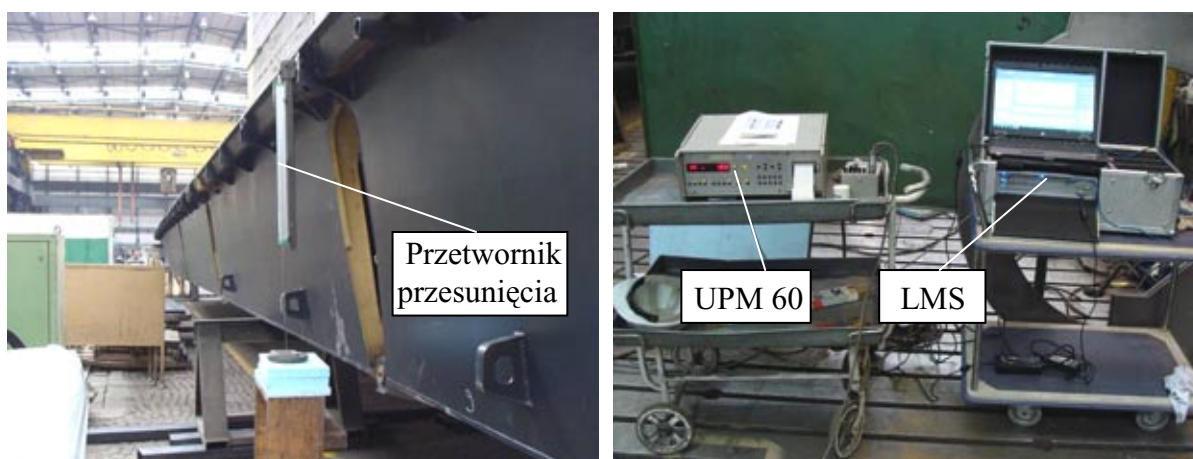
Rys. 4. Widok przetwornika przesunięcia i aparatury pomiarowej
