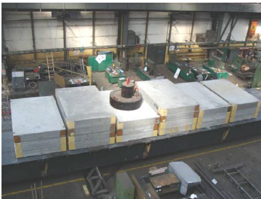
Rys. 12. Widok przęsła obciążonego ciężarami w próbie „U” - dla obciążenia kołowego
