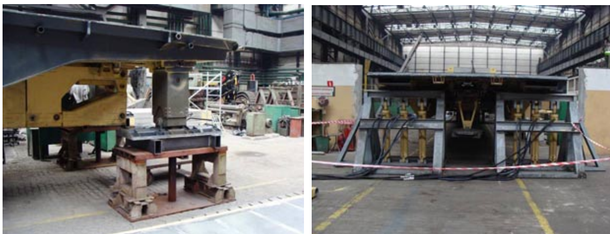
Rys. 6. Sposób podparcia końców przęsła głównego mostu
