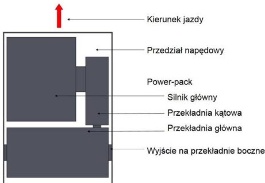
Rys. 5. Uproszczony widok modułowego układu napędowego power-pack w konfiguracji litery U
