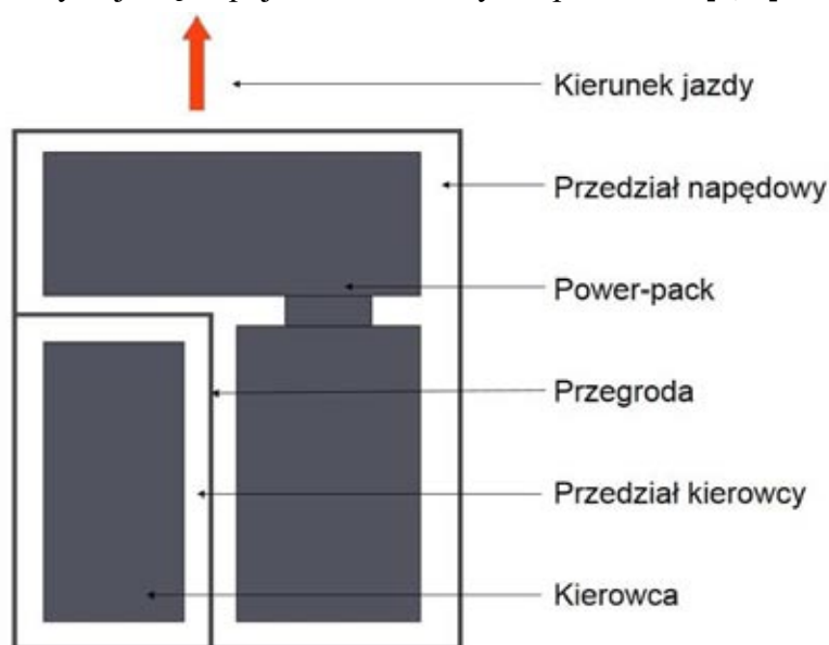
Rys. 3. Uproszczony widok modułowego układu napędowego power-pack w konfiguracji litery L
